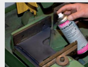
Tous les domaines où il est impératif d'avoir une lubrification sèche et propre, en particulier pour les applications où les poussières et saletés ne doivent pas adhérer aux zones lubrifiées. Exemple : minoterie, fabrique de tuiles, usines d'épices, cimenterie... Élimine bruits de fonctionnement, supporte des charges permanentes, permet l'amélioration des procédés de rodages. Idéal pour surface coulissante à forte charge et à faible vitesse ; sans entretien.
