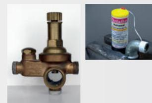
Commencer l'enroulement au début du filet dans la direction du pas et dans l'épaisseur souhaitée. Les recouvrements ne sont pas un problème.
